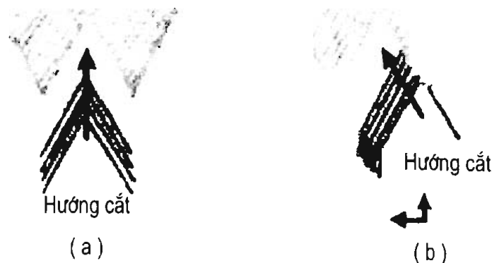
Hình 3-12: Phương pháp tiến dao để cắt ren.
